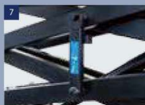
Brazos de apoyo; para proteger al operario durante sus labores de reparación o mantenimiento.
