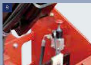
Válvula de descenso manual: si el sistema de mando está averiado o la batería está descargada, es posible emplear esta válvula para bajar la plataforma.
