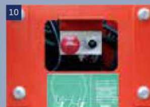
Válvula de desbloqueo manual: si la máquina no funciona, puede empujarla después de pulsar esta válvula.
